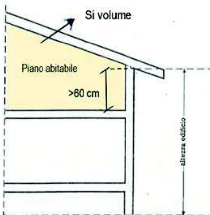
Fig. 13 Edificio con dislivello uguale/maggiore a 60 cm e gronda inclinata
