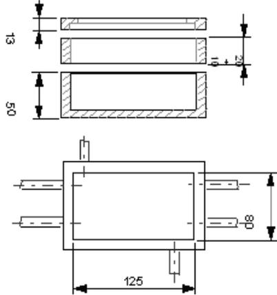
Il pozzetto è costituito da un elemento base, un elemento di sopralzo e da un anello portachiusino.
