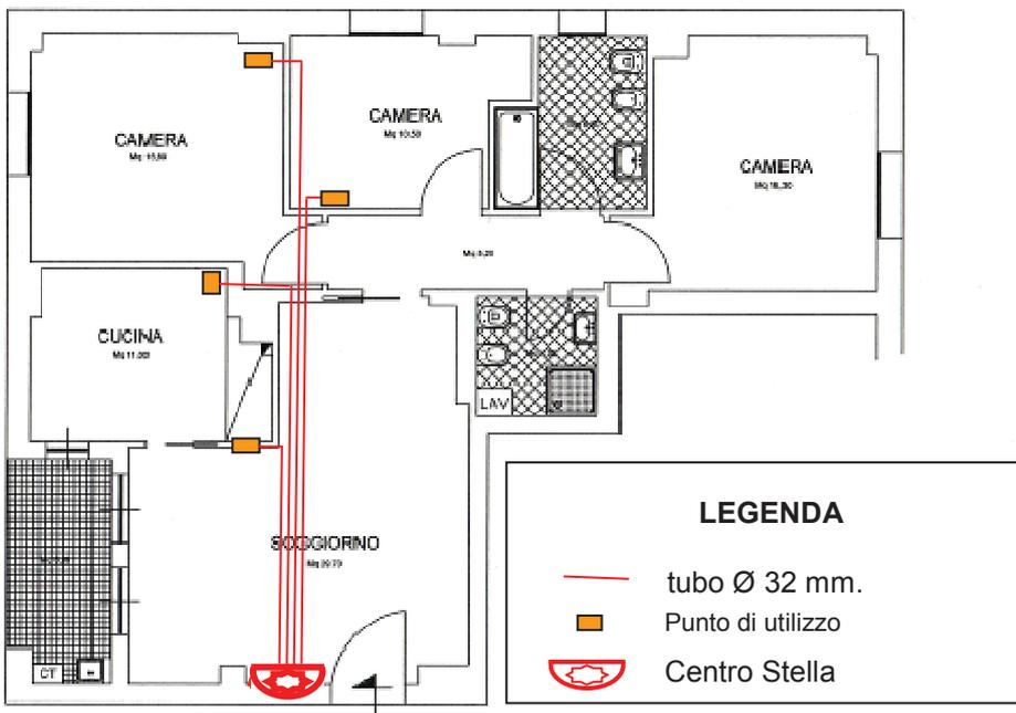
Il centro stella è costituito da un armadietto da incasso tipo commerciale, le cui dimensioni dipendono dai punti di terminazione di TLC previsti all'interno dell'appartamento (dimensioni consigliate 400x400x90 mm LxHxP). Il centro stella dovrà essere raccordato con tubi Ø 32 mm ad ogni punto di accesso TLC ed al quadro elettrico.
