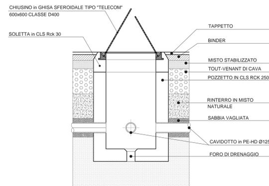
SEZIONE TIPO POZZETTO TELECOM - Sc. 1:20
