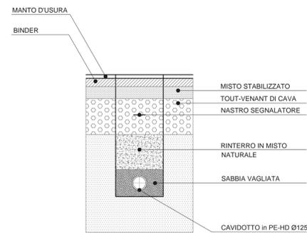
SEZIONE TIPO SCAVO CAVIDOTTO TELECOM - Sc. 1:20
