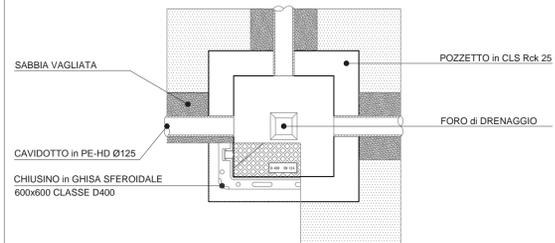
PIANTA TIPO POZZETTO TELECOM - Sc. 1:20
