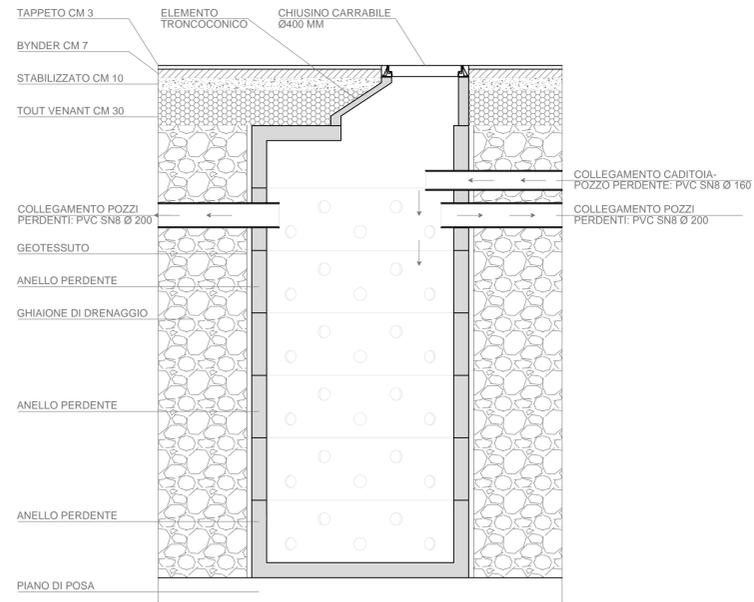
SCHEMA DI REALIZZAZIONE POZZO PERDENTE PER SCARICO ACQUE METEORICHE
